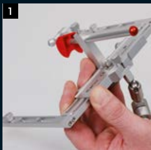
1 准备面弓: 鼻根棒在后方位置安全; 嵌入支架并用翼型螺丝固定其垂直位置
