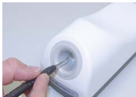
几秒钟之内，建模仪器就在盘管开口中加热
