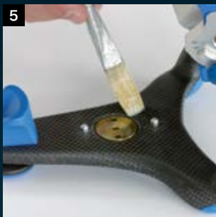
5 运用凡士林薄膜层使粘贴板区域的碳表面绝缘
