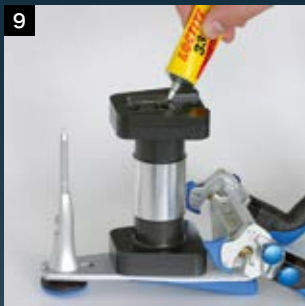
9 在Splitex ® 板的中央位置涂抹两道胶水
