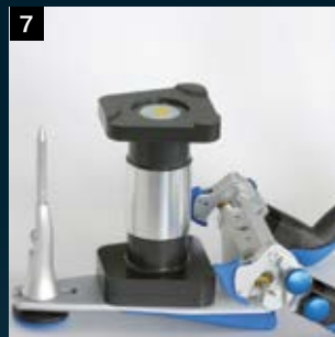
7 将Artex ® 咬合架倒置并将Splitex ® 栓放好
