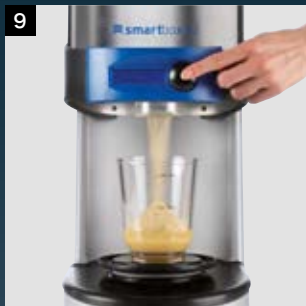
9 Smartbox-按下按钮确定水和石膏粉剂量
