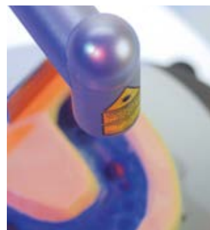
激光束易于钻取定位
