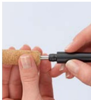
更换探头——无烧伤的风险——扣紧、脱开
