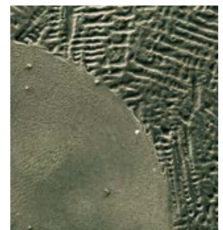
Rissfreie Lasernaht bei einer kohlenstofffreien CoCrMo-Modellguss-Legierung
