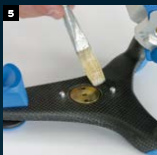
5 Carbonfläche im Bereich der Klebplatte mit dünner Schicht Vaseline isolieren
