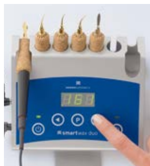
Semplicissima programmazione delle singole temperature
