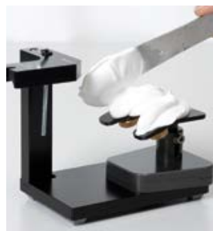
Per fissare la forchetta sul supporto di trasferimento
