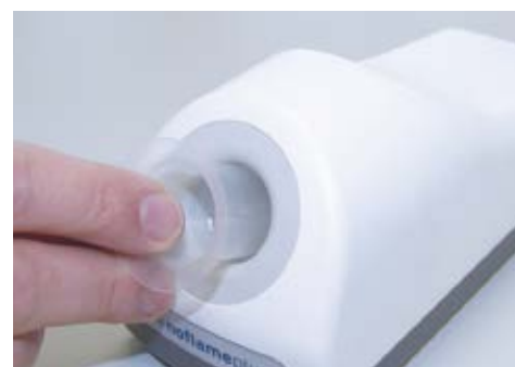
I cappucci di protezione in plastica evitano che l'apertura della bobina si sporchi.
