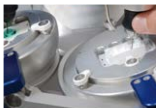
Facile lavorazione dei sottosquadri ribaltando il piano delle calotte sferiche
