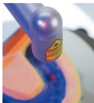
Raggio laser per una facile individuazione della posizione di foratura
