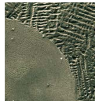
Cordone di saldatura a laser senza crepe in una lega CrCoMo per scheletrati priva di carbonio
