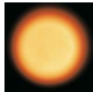
Powierzchnia topionego metalu zaczyna się rozrywać. Natychmiast należy odlać metal
