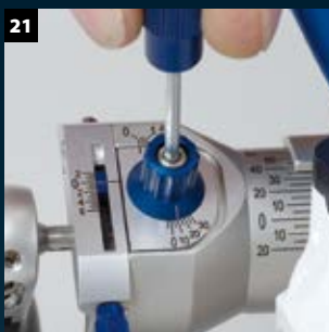
21 Otwarcie śruby Immediate Sideshift ISS – początkowy ruch Bennetta. Szyftt prowadzenia siekaczy nie dotyka talerzyka
