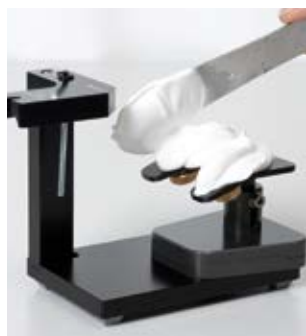
Szybkie mocowanie widelca zgryzowego do stolika
