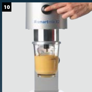
10 Smartmix – mieszanie gipsu na wylewkę
