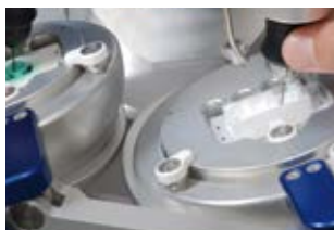
Łatwość wycinania podcieni dzięki ruchomym stolikom sferycznym
