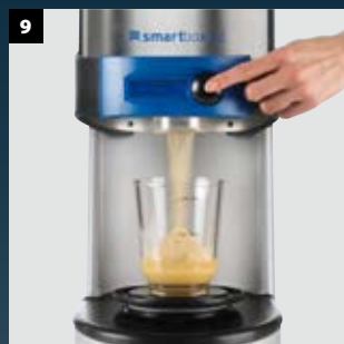
9 Smartbox – dozowanie wody i gipsu po wciśnięciu guzika
