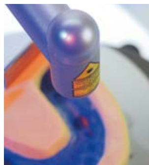
Punktowa emisja promieni laserowych pozwala na dokładne ustalenie pozycji nawiertu
