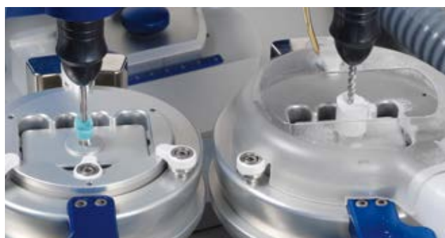
Zainstalowanie zestawu Teleskopkit w urządzeniu Ceramill Multi-x
