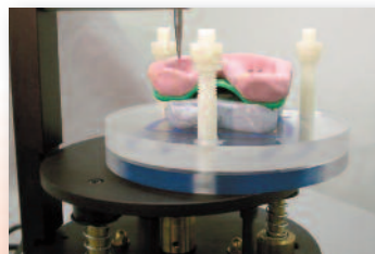
Esecuzione dei fori con la foragessi DVA
