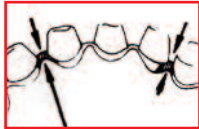
Unione di elementi in cera per evitare distorsioni
