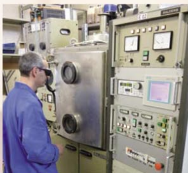
Miroirs: maîtrise de la dépose sous vide du métal sur le verre.
