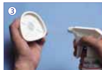
Aislamiento escayola contra escayola.
