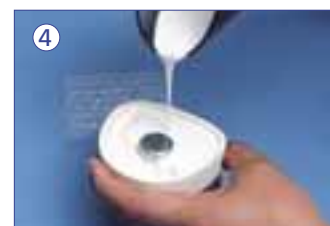
Après avoir fixé la cupule avec aimant sous le socle, coulée du plâtre pour le socle secondaire.
