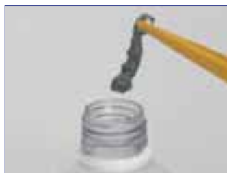
Revêtement en céramique après le traitement avec Ceramex
