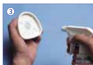
Isolare gesso / gesso.
