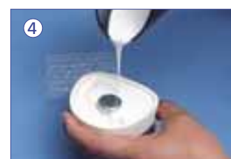
Dopo l'inserimento del porta-calamite con la calamite, colare la base secondaria.
