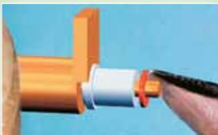
Inserta el espaciador cerámico y el anillo calcinable dentro del contenedor moldeado.
