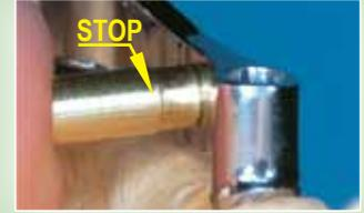
Insertando el conformador del contenedor dentro del orificio y los elementos en su lugar. asegúrese de no pasar la marca de "stop" cuando aplique resina.
