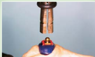
Raylı tabanın 3 yüzünü (4ncü tahliye yüzü hariç titanyum küresel kafanın sökülebilmesi için) mum ile kaplayarak mum modele bağlayın
