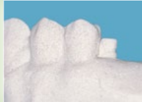
Modello duplicato in rivestimento con la riproduzione del formato della cappetta
