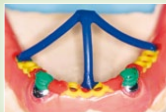
Completare la modellatura anche con cera, applicare i perni di colata e fondere
