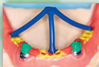
Το μοντελάρισμα του σκελετού τελειωμένο με τους αγωγούς χύτευσης
