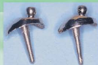
Οι άξονες με τις σφαίρες χυτευμένοι. Είναι δυνατόν η σφαίρα να μην τοποθετηθεί στο κέντρο του άξονα
