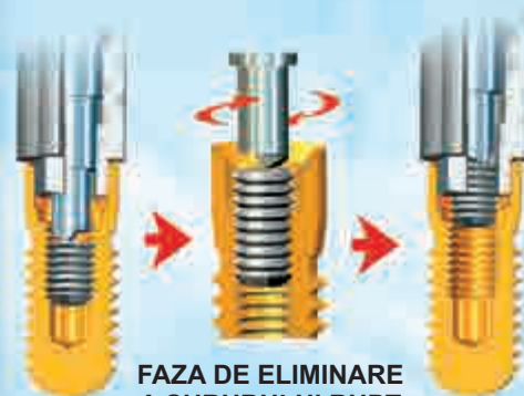
ALEZOR CU GHEARĂ ÎN CONTACT CU ȘURUBUL RUPT
