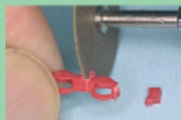
OT BOX SPECIAL: TĂIAȚI ȘI FOLOȘIȚI DOAR PORȚIUNEA CASETEI
