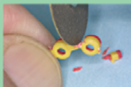
OT BOX CLASIC: SE FOLOSEȘTE DOAR PORȚIUNEA CASETEI, TĂIND PĂRȚILE ÎN PLUS
