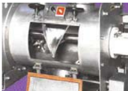
Malaxeur en socle de charrue pour mélanger les revêtements
